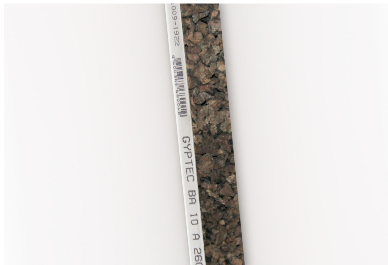
Figura 1: Placa composta de gesso laminado com isolamento incorporado em aglomerado de cortiça expandida
