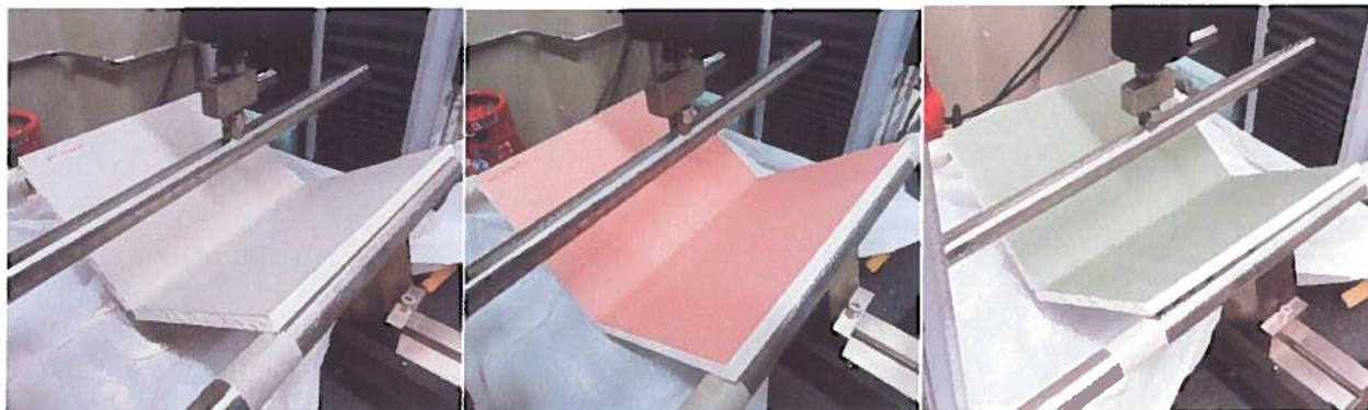
**Figura 7:** Rotura de um dos provetes de cada tipo de placa ensaiada.
