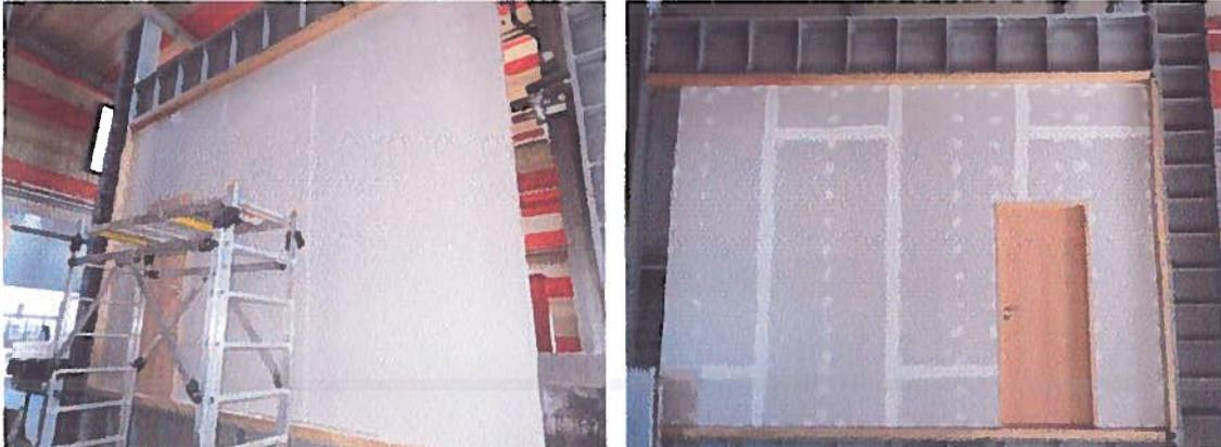
**Figura 14:** Montagem do primeiro provete no pórtico metálico.
