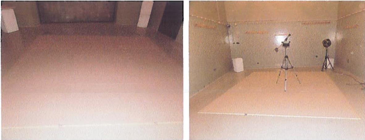
**Figura 1:** Montagem do primeiro provete no interior da câmara reverberante.
