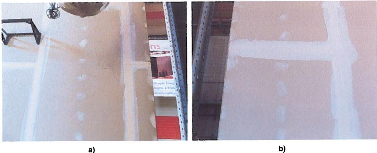
**Figura 26:** Ensaio de carga por impacto de corpo mole no segundo provete (divisória de estrutura dupla) – saco 50 kg – dano estrutural: a) face de impacto; b) face oposta ao impacto.
