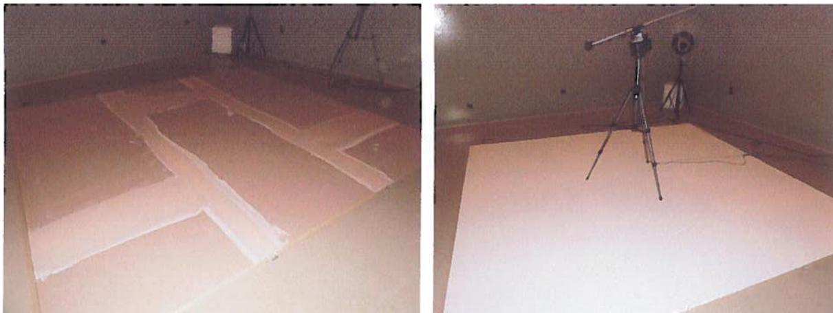
**Figura 2:** Montagem do segundo provete no interior da câmara reverberante (barramento da juntas à esquerda e acabamento final à direita).
