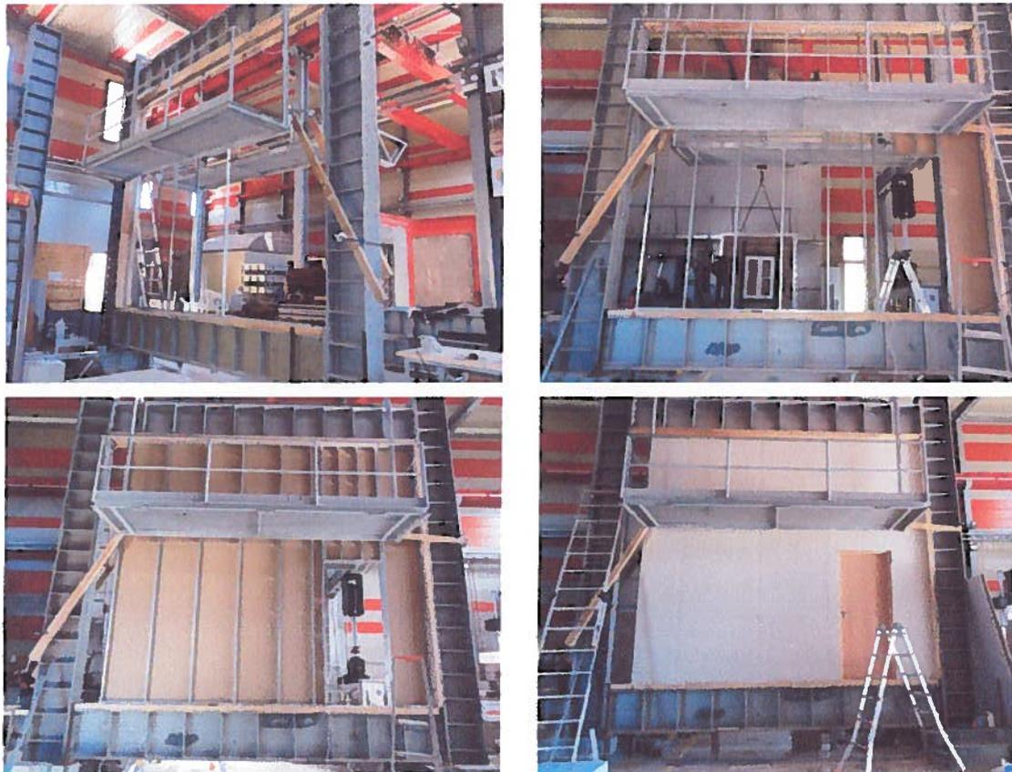
**Figura 17:** Montagem do segundo provete no pórtico metálico.
