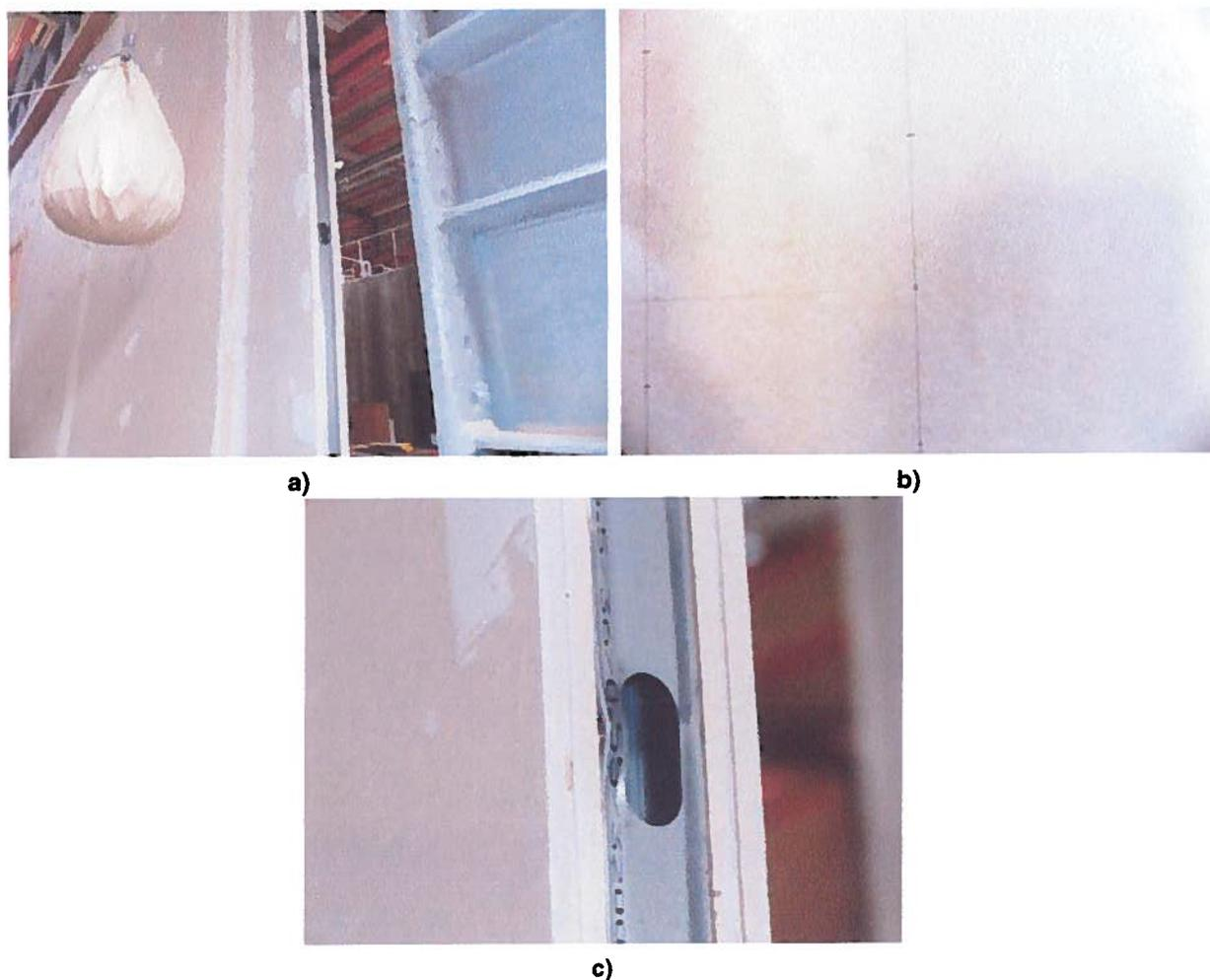
**Figura 25:** Ensaio de carga por impacto de corpo mole no primeiro provete (divisória de estrutura simples) – saco 50 kg – dano estrutural: a) face de impacto; b) face oposta ao impacto; c) perfil montante.
