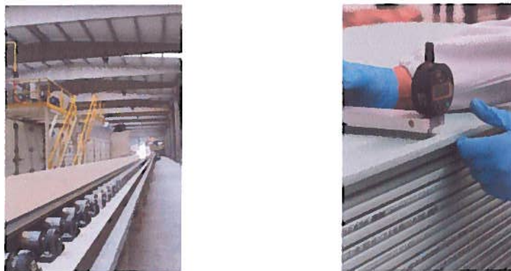
Figura 11: Fabrico das placas de gesso laminado.
