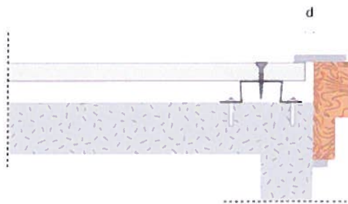
Figura 75: Aplicação das placas no limite da abertura.
