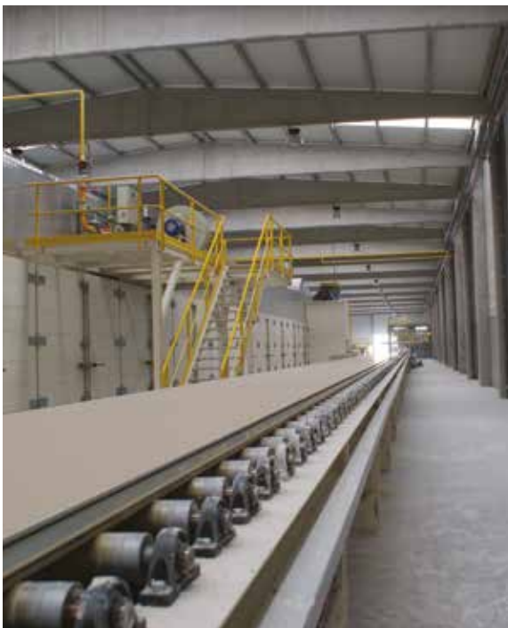
Figura 1: Fabricación de las placas de yeso laminado.
